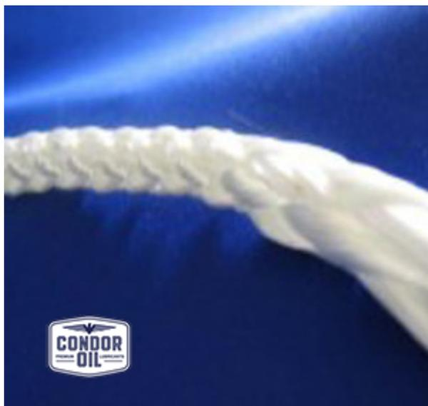
**Волокна из энергосберегающего стекла** наиболее часто применяются в качестве армирования в композитных материалах: стекловолокно не очень дорогое и обладает отличными механическими, тепловыми, диэлектрическими и химическими свойствами. Прочностные свойства соответствуют некоторым металлам (например, алюминиевым сплавам), при этом специфический вес меньше, чем у металлов.
