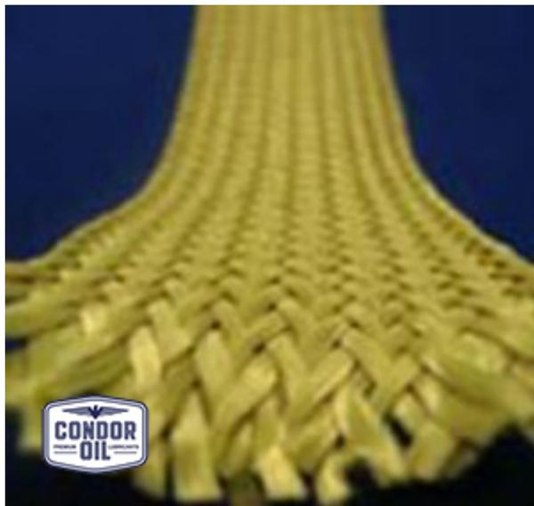
**Арамид, также известный под названием кевлар или тварон,** относится к новой группе химических волокон. Он характеризуется среди прочего высокой прочностью, высоким модулем эластичности, низкой плотностью и большой долговечностью.
