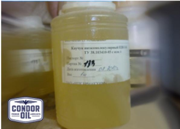
**Каучук низкомолекулярный ПДИ-ЗАК** применяется как эластичное связующее для приготовления заливочных и пропиточных композиций, а также компаундов для изделий электронной, электротехнической и радио-промышленности, герметиков, клеев, шпаклевок, покрытий типа «Физпол» для спортивных сооружений, как эластичная эпоксидная смола.
